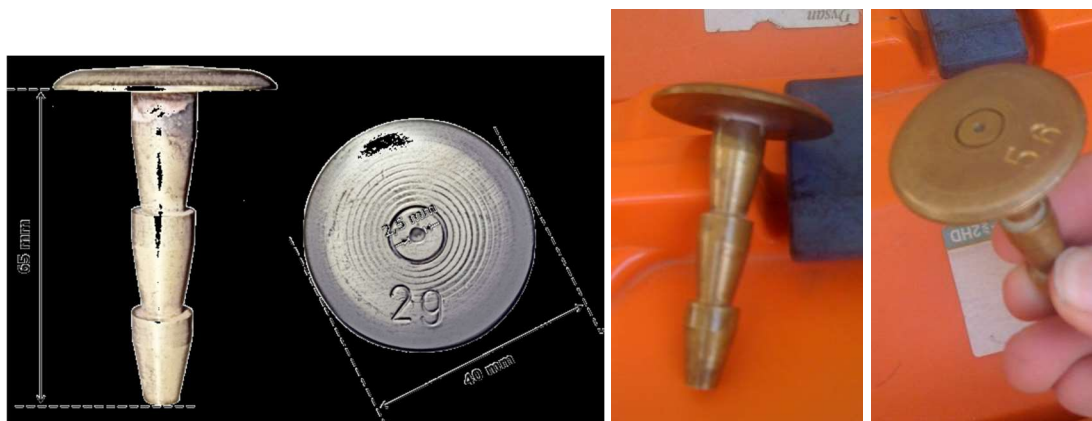
Εικόνα 1. Ορειχάλκινο μπουλόνι ορισμού σημείου μετρήσεων GPS ή/και μικροβαρυτομετρικού σταθμού. Κατάλληλα σχεδιασμένη κεφαλή για την εστίαση των οργάνων κατά την διάρκεια των δορυφορικών παρατηρήσεων GPS.
