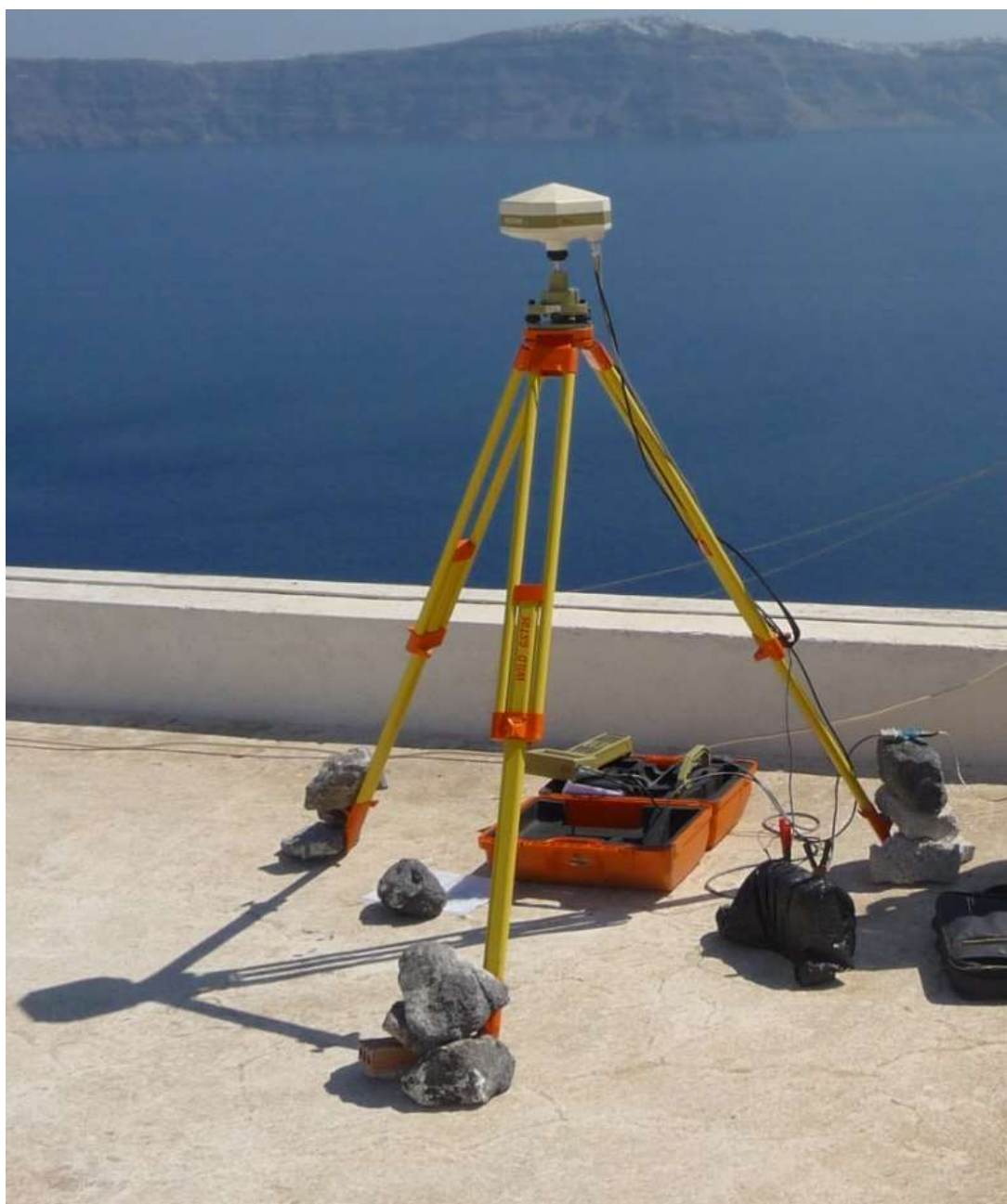
Εικόνα 2. Μέτρηση σημείου του δικτύου της Σαντορίνης (Θηρασία) με τη χρήση γεωδαιτικού δέκτη GPS LEICA SR399.
