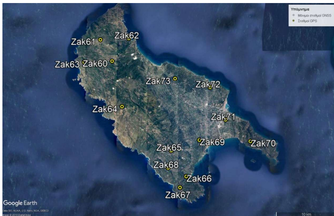
Εικόνα 6. Τοπικό Δίκτυο GPS Ζακύνθου. Σημειώνονται ο μόνιμος σταθμός GNSS (ZAKY) που λειτουργεί στην περιοχή από την εταιρεία ΜΕΤΡΙΚΑ ΑΕ.
