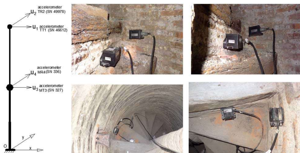
Σχήμα 4.14: Σκαρίφημα της κατανομής καθ' ύψος της εντοπισμένης του μινιάρ του καθεδρικού ναού στη Βέροια και τα εγκατεστημένα επιταχυνσιόμετρα στο εσωτερικό του (Lekidis et al., 2018)
