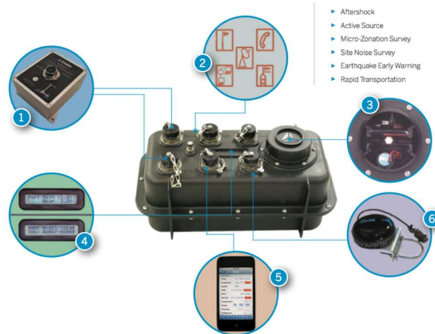
Σχήμα 2.1: Ψηφιοποιητής refttek 130S-01, 24 bit. (1) Τρία ή έξι κανάλια σύνδεσης με αισθητήρες εδαφικής κίνησης. (2) Σύνδεση με το διαδίκτυο. (3) Θέσεις προσαρμογής δίσκων μνήμης (flash disks). (4) Οθόνη παρακολούθησης της λειτουργίας του οργάνου. (5) Σύνδεση για επικοινωνία με το όργανο, καθορισμό παραμέτρων κλπ. (6) Σύνδεση με GPS. Πηγή:
