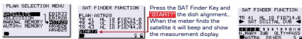
Σχήμα 6.7: Διαδικασία προσανατολισμού της δορυφορικής κεραίας του CSτ με φορητό αναλυτή δορυφορικού φάσματος
