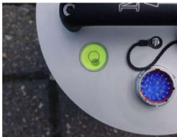
Σχήμα 2.6: Η οριζοντίωση του σεισμομέτρου γίνεται με τη βοήθεια φυσαλίδας στην πάνω επιφάνεια του οργάνου Πηγή: https://www.guralp.com/documents/MAN-040-0001.pdf
