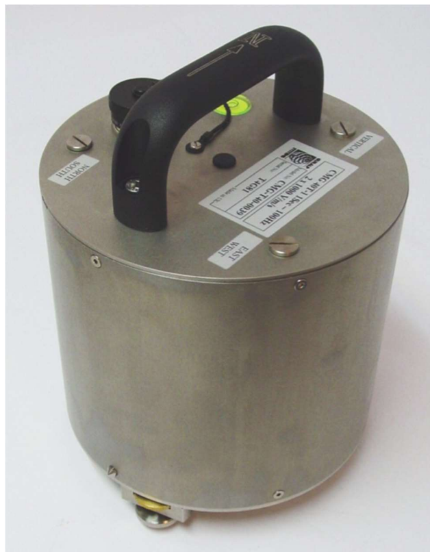
Σχήμα 2.5: Σεισμόμετρο τριών συνιστωσών GURALP CMG40 T Πηγή: https://www.guralp.com/documents/MAN-040-0001.pdf
