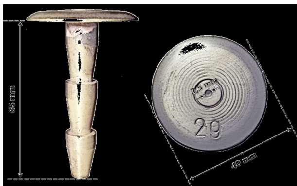
Εικόνα 1. Ορειχάλκινο μπουλόνι ορισμού σημείου μετρήσεων GPS σταθμού. Κατάλληλα σχεδιασμένη κεφαλή για την εστίαση των οργάνων κατά τη διάρκεια των δορυφορικών παρατηρήσεων GPS.
