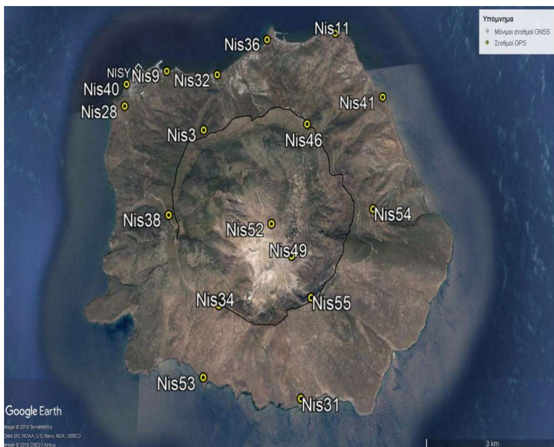
Εικόνα 18. Δίκτυο GPS Νισύρου, σημειώνεται και ο μόνιμος σταθμός NISY.
